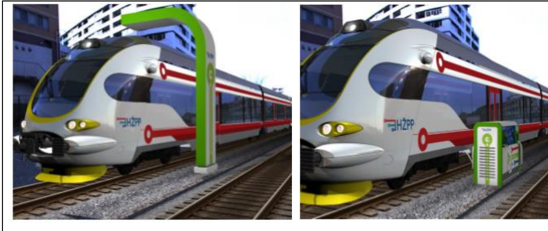
Slika 2. Izvedbe stabilnih električnih priključaka za punjenje baterija
